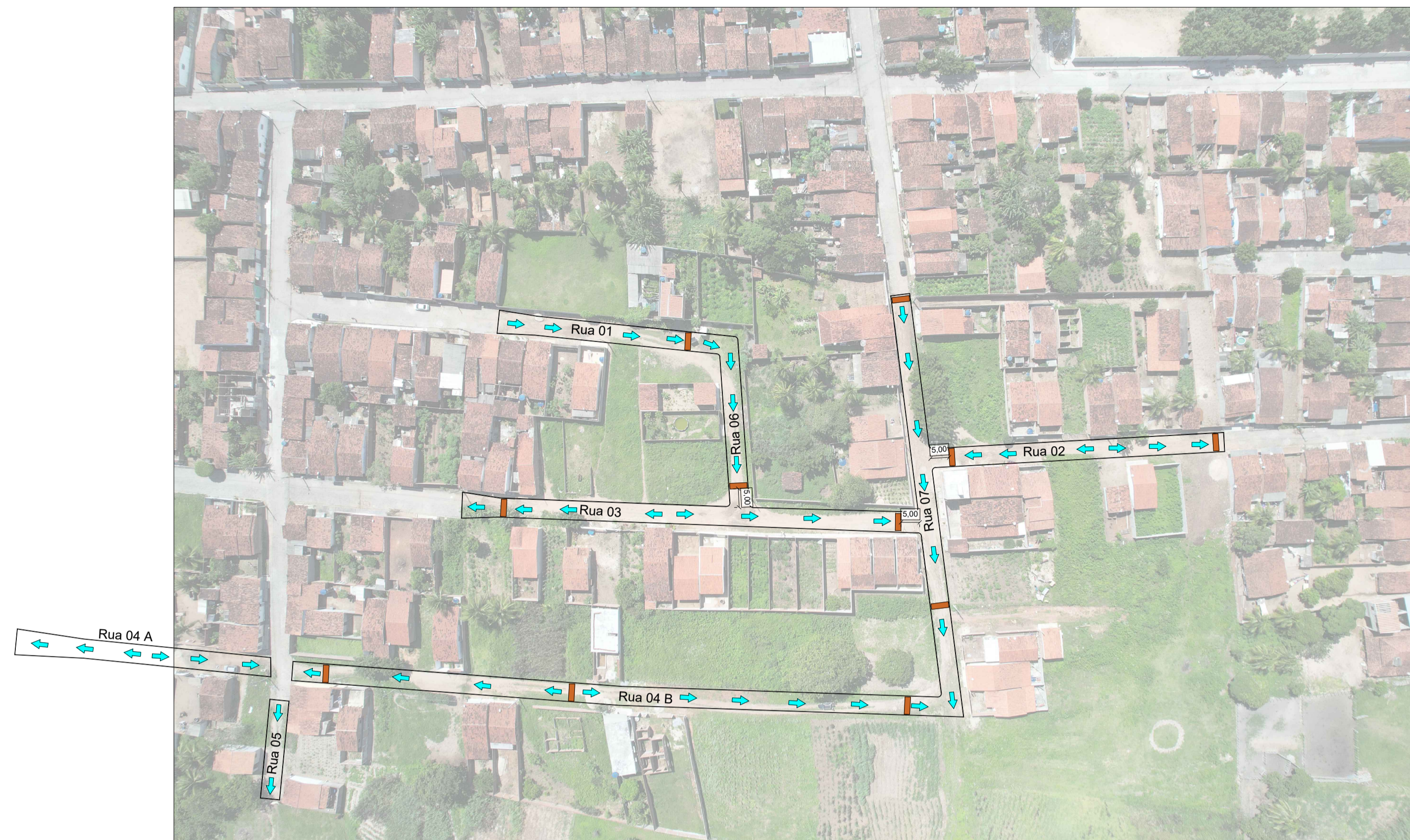
Planta fluxo de drenagem superficial e lombadas
